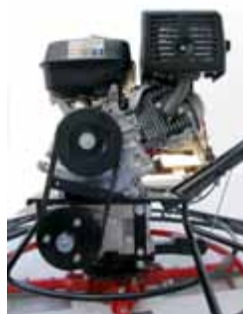
Widok sprzęgła odśrodkowego po zdjęciu osłony
